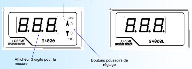
La face avant de l'appareil est composée de:
