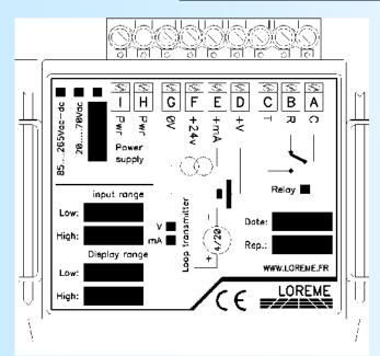
Alimentation: bornes I et H. borne D (+), G (-). Entrée V: Entrée mA: borne E (+), G (-).
